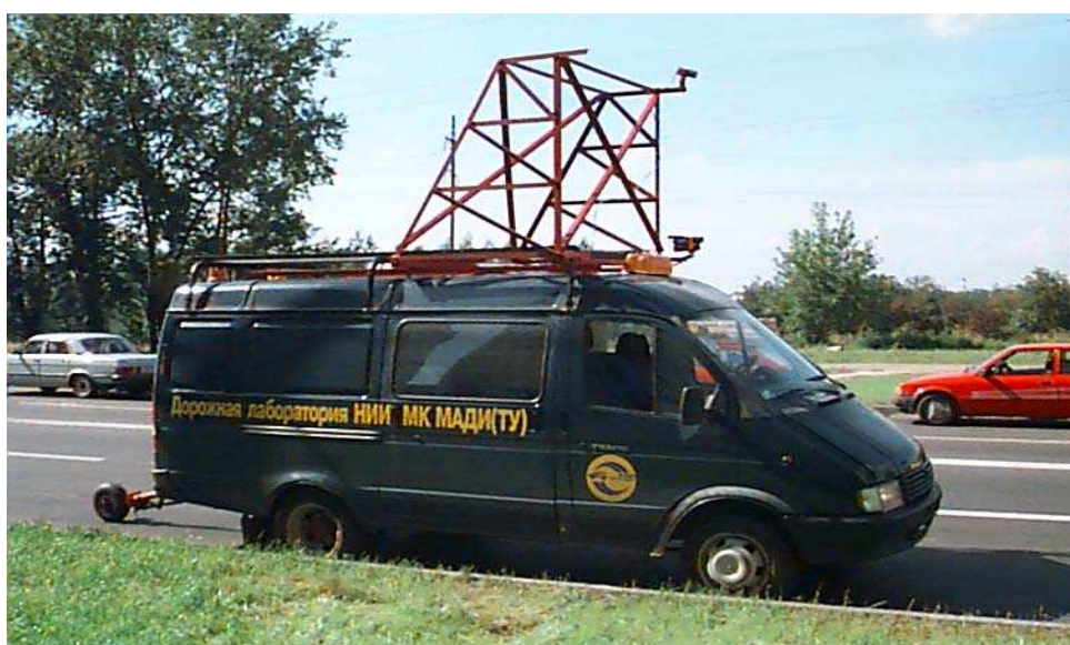
Рис. 2. Общий вид передвижной лаборатории видеокomпьютерного сканирования Технический состав комплекса указан в таблице 1.
