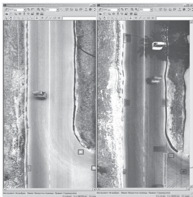
Рис. 3. Сравнение данных сканирования, полученных с интерферометром в полгода. Справа — четко видны ремонтные карты.
